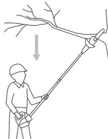
2- Stehen Sie niemals auf einer Leiter oder einer anderen Art von instabiler Unterst tzung, w hrend Sie die Hochentaster-S ge verwenden. Bedienen Sie die Hochentaster-S ge immer mit beiden H nden. Halten Sie beim Schneiden einen festen, gleichm ssigen Druck auf die Hochentaster-S ge, aber versuchen Sie nicht, die S ge durch das Holz zu zwingen. Verwenden Sie die Hochentaster-S ge nicht, um  ste zu schneiden, die im Durchmesser gr sser sind als die L nge der F hrungsschiene.
